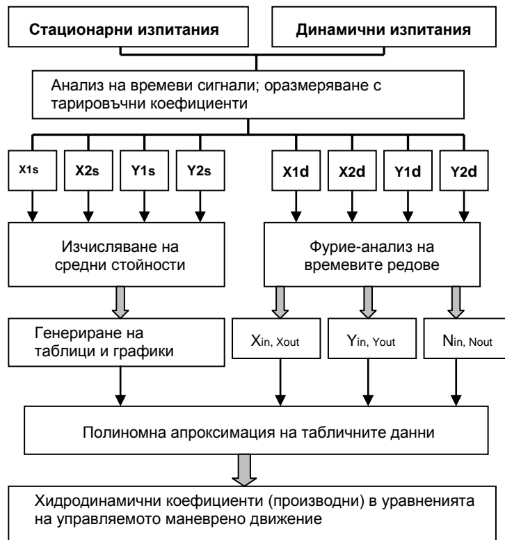
Фиг. 7.4 Схема на обработката на данните от РММ-изпитания
